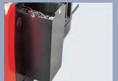
Batterie seitlich herausrollbar
