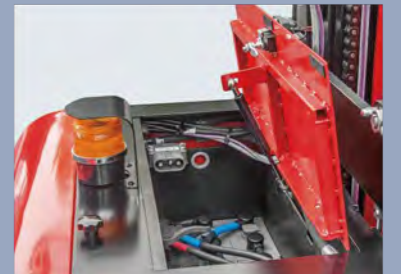
Nach dem Öffnen der Klappe besteht einfacher Zugriff auf Hydraulikeinheit, Elektroniksteuerung und Motor
