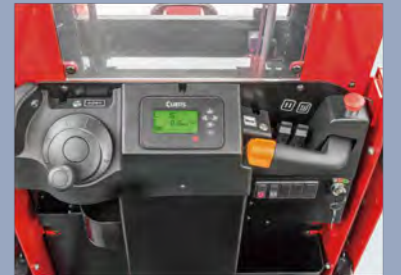
FREIER Beschleunigungshebel mit Sensor beugt Fehlbedienung vor
