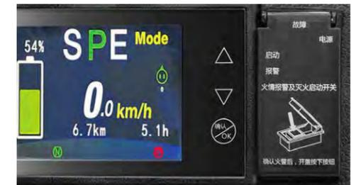
Die CATL Hochvolt – Batterie besitzt schon in Standardversion einen automatischen Feuerlöscher.
