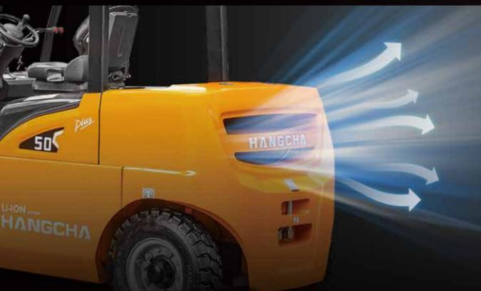
Eine große Lüfteröffnung gewährleistet die schnelle Wärmeabfuhr.
