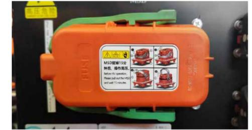
Das elektrische System ist mit Hochspannungsverriegelungen, Isolationsüberwachung, Erfassung von Isolationsfehlern und sonstigen normgerechten Sicherheitsmerkmalen ausgestattet. Der eingebaute MSD – Wartungsschalter erlaubt die Abschaltung auf Knopfdruck, auch im Hinblick auf die Wartung.
