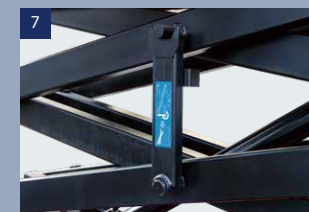
7 Stützarme: Zum Schutz des Bedieners bei Reparatur- und Wartungsarbeiten
