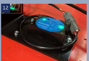
12 Neigungssensor: beim Heben und Fahren an einem Gefälle, prüft der Sensor automatisch den Neigungswinkel der Maschine, wenn die Neigung größer ist als der Nennwinkel, löst der Alarm für den Bediener aus
