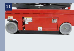
11 Ein automatischer Kippschutz greift ein, sobald bei einem Hub oberhalb von 2 m auf unebenem Grund Bewegungen stattfinden
