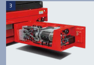
3 Hydraulisches und elektrisches System
