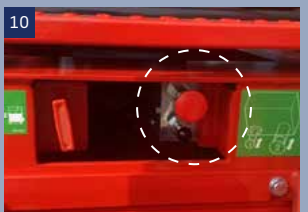
10 Manuelles Freigabe-Ventil. Wenn die Fahrfunktion der Plattform nicht reagiert, kann die Maschine nach betätigen des Ventils manuell verfahren werden
