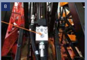
8 Explosionsgeschütztes Ventil zum Schutz vor Unfällen bei Ölaustritt
