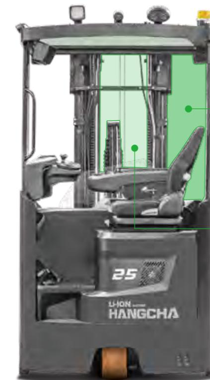
Stabil und trotzdem kompakt wurde das Hubgerüst entworfen, so dass der Blick um den Mast herum so wenig wie möglich versperrt wird.
