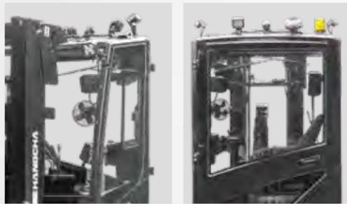
/ Das leistungsstarke Heizgebläse ist imstande, das Fahrzeuginnere noch bei  $-30^{\circ}\text{C}$  gesichert auf  $-10^{\circ}\text{C}$  zu erwärmen.
