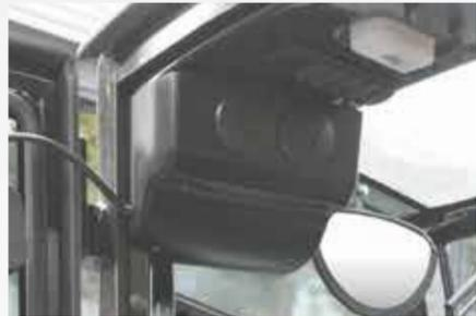
Die voll gekapselte Kabine bietet Schutz vor Korrosionsangriff und Kurzschluss, ist wasserdicht, isoliert und erfüllt sämtliche Voraussetzungen zum Einsatz bei  $-30^{\circ}\text{C}$ . Bei einem Test in einem Kühllager gelang es noch bei  $-30^{\circ}\text{C}$ , die Innentemperatur bei über  $0^{\circ}\text{C}$  zu halten.
