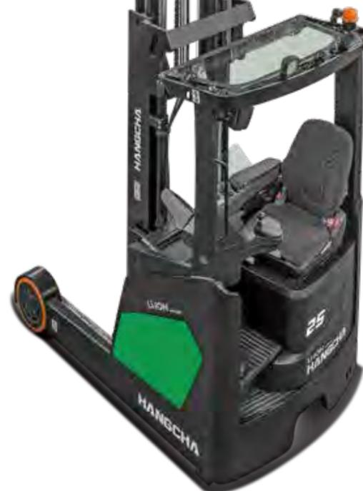
**Optimale Sicht auch beim Stapeln – hier hilft die angepasste Struktur des Hubgerüsts und die Anordnung der Rohre.**
