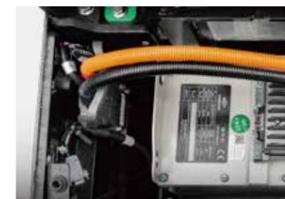
Sichere Installation der Batterie: Der Netzstecker ist im Fahrzeug befestigt.
