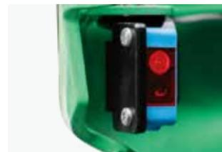
Ein Fußsensor bremst das Fahrzeug (gegebenenfalls bis zum Stillstand), sobald er feststellt, dass sich ein Fuß des Fahrers außerhalb der Plattform befindet (Fahrermodell).
