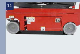
11 Ein automatischer Kippschutz greift ein, sobald bei einem Hub oberhalb von 2 m auf unebenem Grund Bewegungen stattfinden
