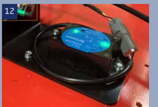
12 Neigungssensor: beim Heben und Fahren an einem Gefälle, prüft der Sensor automatisch den Neigungswinkel der Maschine, wenn die Neigung größer ist als der Nennwinkel, löst der Alarm für den Bediener aus
