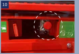
10 Manuelles Freigabe-Ventil. Wenn die Fahrfunktion der Plattform nicht reagiert, kann die Maschine nach betätigen des Ventils manuell verfahren werden
