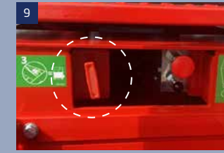
9 Manuelles Absenkenventil: Selbst bei niedrigem Batteriestatus oder Versagen der Steuerung lässt sich die Bühne mit diesem manuellen Absenkenhebel immer noch absenken
