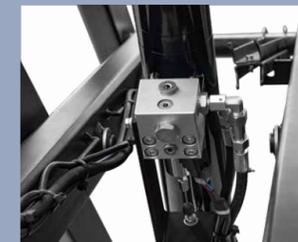
Explosionsschutzgeschütztes Ventil zum Schutz vor Unfällen bei Ölaustritt
