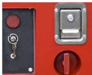
Selbst bei niedrigem Batteriestatus oder Versagen der Steuerung lässt sich die Bühne mit diesem manuellen Absenkehebel immer noch absenken.
