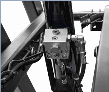
Explosionssgeschütztes Ventil zum Schutz vor Unfällen bei Ölaustritt
