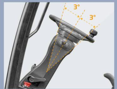
Der Winkel des Lenkrads ist einstellbar
