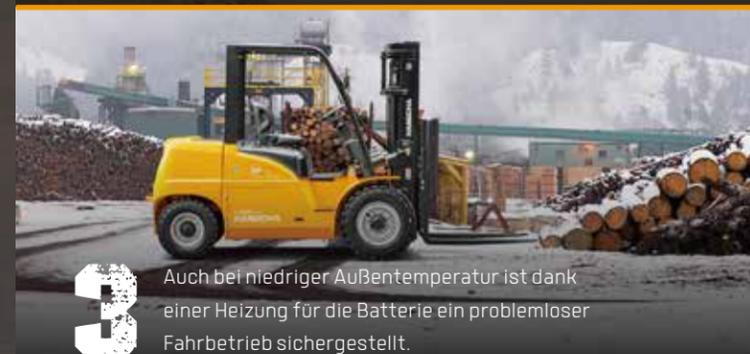
**3** Auch bei niedriger Außentemperatur ist dank einer Heizung für die Batterie ein problemloser Fahrbetrieb sichergestellt.
