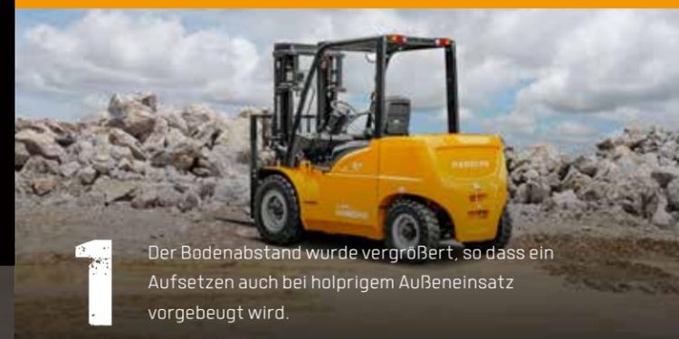
**1** Der Bodenabstand wurde vergrößert, so dass ein Aufsetzen auch bei holprigem Außeneinsatz vorgebeugt wird.
