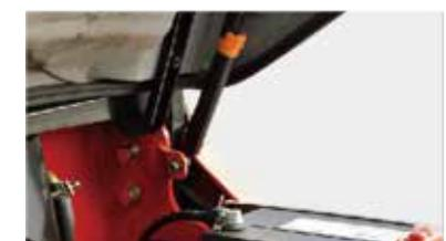
Die Verriegelung der Motorhaubendämpfer und Feststellbremse helfen die Sicherheit zu ergänzen.
