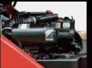
Der neue Stauluftfilter und die Dichtung mit Sicherheitsfilter ist langlebig. Sie sind beständig gegen Korrosion und Stoße und bieten bessere Filtrationseffizienz und Ansaugwiderstand.
