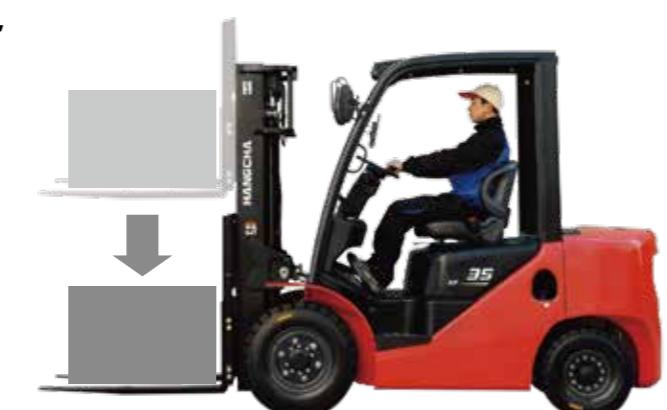
Das Anwesenheitserkennungssystem des Fahrers umfasst das Heben / Kipp- und Fahrsperrfunktion. Wenn der Fahrer den Sitz verlässt sperrt das System automatisch das Heben/Kippen und deaktiviert die Fahrt, um die Sicherheit zu gewährleisten.
