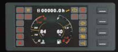
Interaktive Instrumententafel: Das Instrument verfügt über ein 4,0-Zoll-Farb-LCD-Display mit vier interaktiven Tasten und eine CAN-Bus-Kommunikationsfunktion. Das Kommunikationsprotokoll ist mit den Standards CANopen und SAE J1939 kompatibel.
