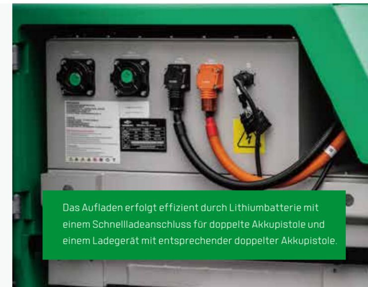
Das Aufladen erfolgt effizient durch Lithiumbatterie mit einem Schnellladeanschluss für doppelte Akkupistole und einem Ladegerät mit entsprechender doppelter Akkupistole.
