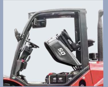
Maschine durch leicht zu öffnende Klappe zugänglich.
