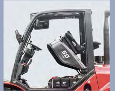
Maschine durch leicht zu öffnende Klappe zugänglich.
