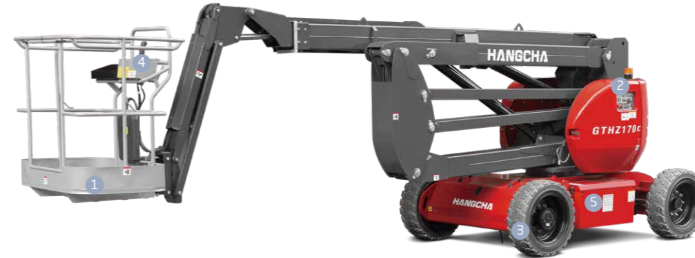
Auch mit dem intuitiv zu bedienenden Steuerkasten unten am Auslegerbaum lassen sich sämtliche Aktionen durchführen.
