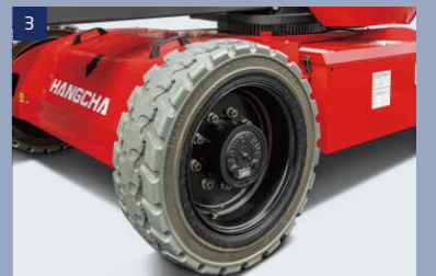
Die Reifen mit Schaumstofffüllung gewährleisten auch in schwierigem Gelände den problemlosen Einsatz
