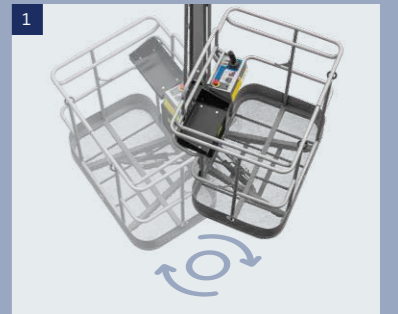
Die Bühne lässt sich jeweils um 140° nach links bzw. rechts schwenken
