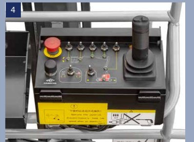
Mit dem Steuerkasten in der Plattform ist der Einsatzort schnell anzusteuern. Die Regler sind einfach verständlich
