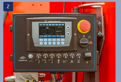
Auch mit dem intuitiv zu bedienenden Steuerkasten unten am Auslegerbaum lassen sich sämtliche Aktionen durchführen.
